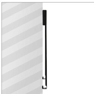
Flaches Design montiert Bildschirme nur 20mm von der Wand entfernt
