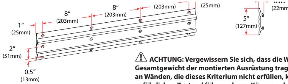
**! ACHTUNG:** Vergewissern Sie sich, dass die Wand das vierfache Gesamtgewicht der montierten Ausrüstung tragen kann. Bei einer Befestigung an Wänden, die dieses Kriterium nicht erfüllen, kann dies zu einem instabilen, gefährlichen Zustand führen, der zu Körperverletzungen oder Sachschäden führen könnte. Wenden Sie sich an einen Statik- oder Baufachmann, wenn Sie nicht genau wissen, was dies für Ihre jeweilige Anwendung bedeutet.
