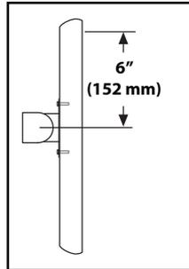
Bei der Bestimmung der Montagehöhe wird von einem Abstand von 152 mm (6") zwischen der Mitte der Monitormontagelöcher und der Oberkante des Bildschirms ausgegangen. Wenn der tatsächliche Abstand kleiner ist, sollten Sie die Montagehöhe entsprechend vergrößern; wenn er größer ist, sollten Sie ihn entsprechend verringern.
