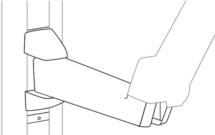
\*Das Produkt wird mit Rotationsanschlag geliefert, um zu verhindern, dass der Verlängerungsarm gegen die Wand schlägt.
