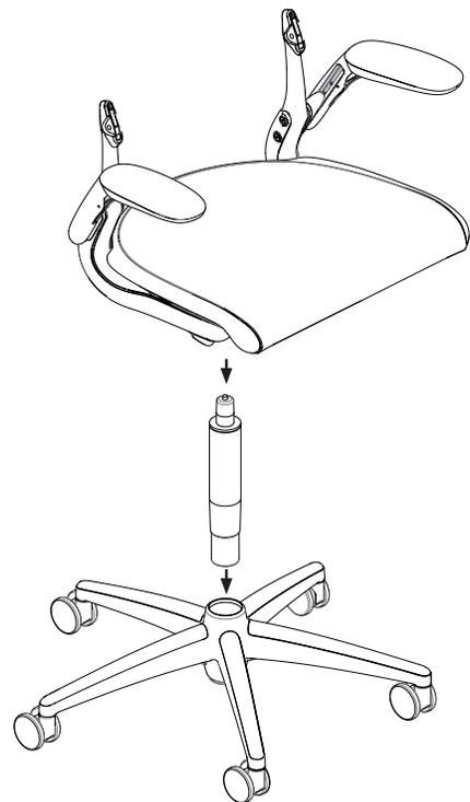
Drücken Sie zunächst den Gaszylinder in den 5-Sterne-Sockel und montieren anschließend die Sitzfläche an dem Zylinder.
