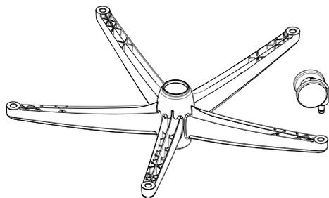
Stellen Sie den 5-Sterne-Sockel auf den Kopf und installieren die Rollen, indem Sie den Metallschaft fest in die entsprechende Öffnung drücken, bis er vollständig sitzt.
