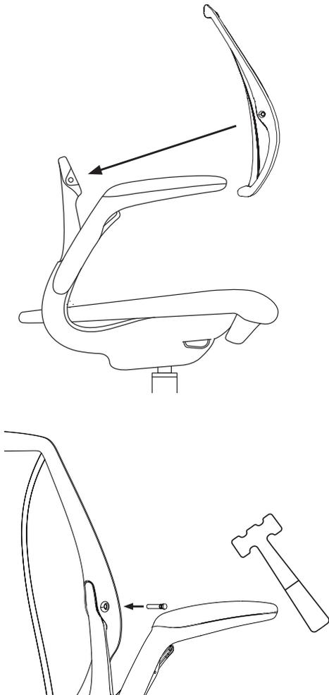
Montieren Sie die Rückenlehne mit den 2 Bolzen an dem Sitzrahmen.
