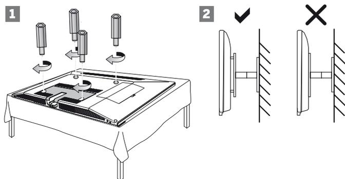
Die Loewe VESA-Adapterbolzen dienen dazu, die Stabilität und den Mindestabstand von 5mm zwischen Geräterückwand und VESA-Halter zu gewährleisten (siehe Abbildung 2). Der VESA-Halter darf keinesfalls auf der Geräterückwand aufliegen.
