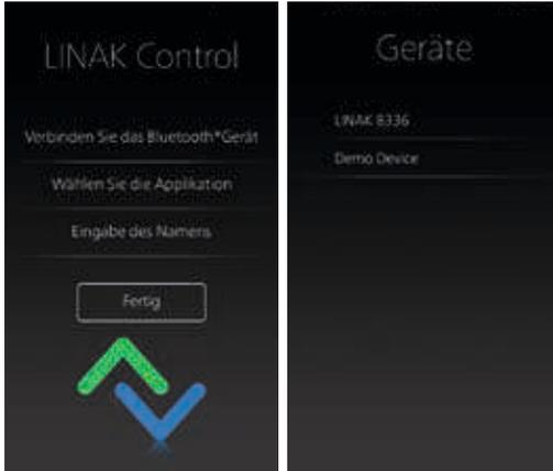
Öffnen Sie die Desk Control App. Drücken Sie "Verbinden Sie das Bluetooth® Gerät". Eine Liste von LINAK Bluetooth® Adaptern wird sichtbar. Klicken Sie auf den, den Sie verbinden möchten.
