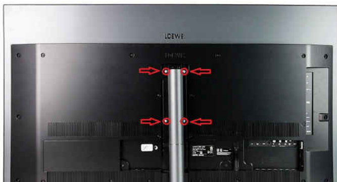
Abb. 1: Schrauben an Rückseite des Loewe TVs lösen
