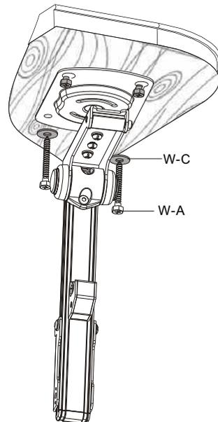
Nach dem Ausrichten der Halterung schrauben sie die beiden hintern Schrauben ebenfalls ein und ziehen alle 4 Schrauben fest an.
