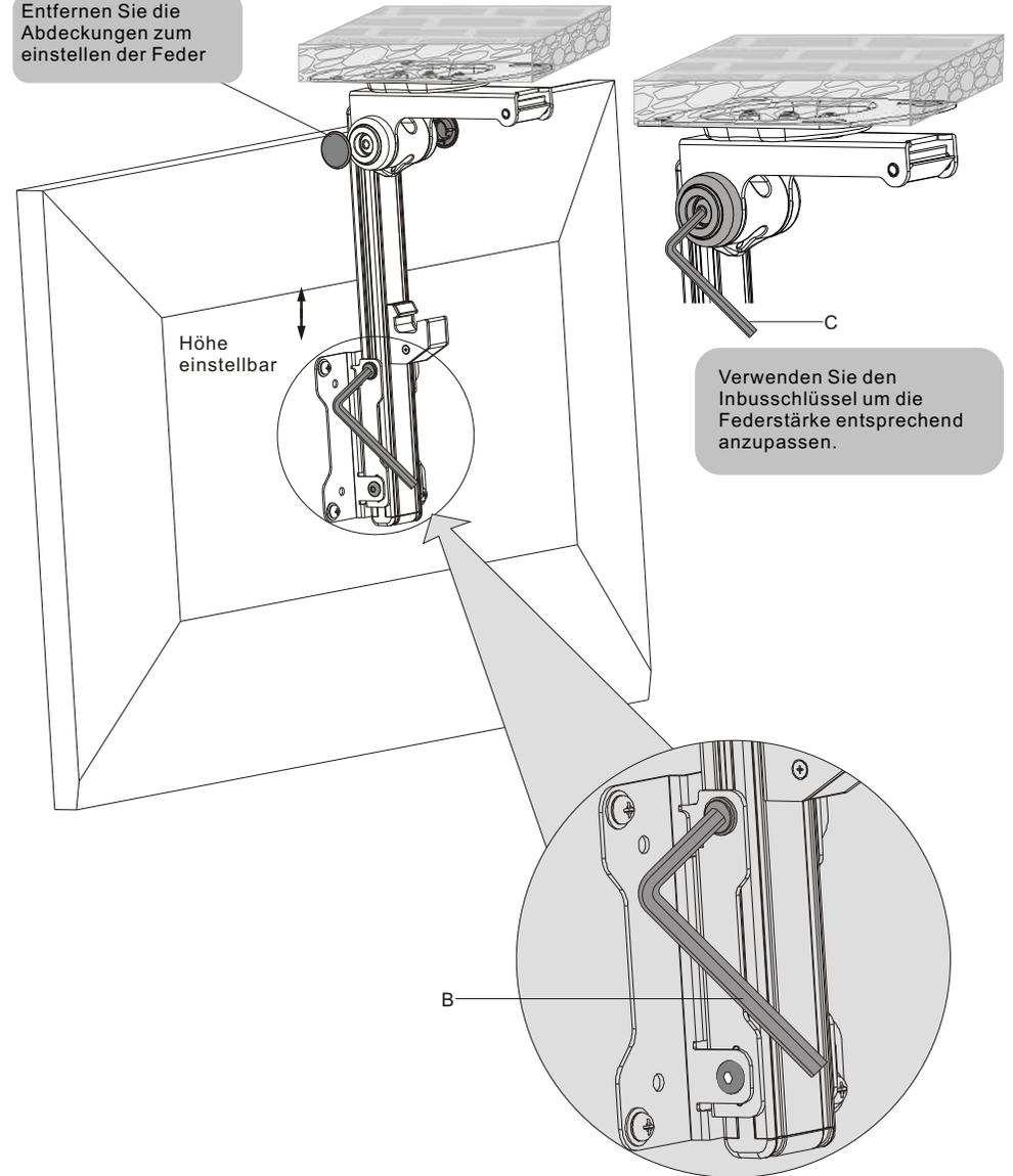
Verwenden Sie den Inbusschlüssel um die Federstärke entsprechend anzupassen.
