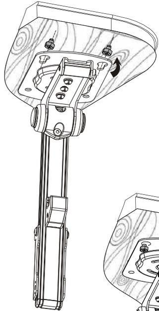
Montieren Sie zunächst die vorderen 2 Schrauben, schieben dann die Deckenhalterung ein und ziehen die beiden Schrauben leicht an.
