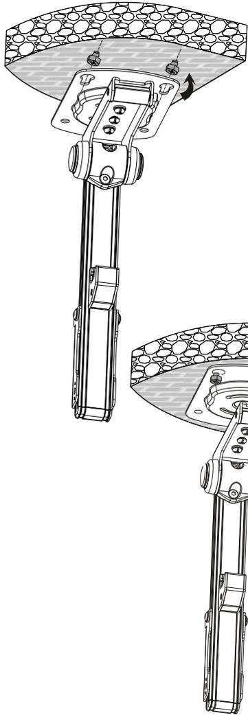
Montieren Sie zunächst die vorderen 2 Schrauben, schieben dann die Deckenhalterung ein und ziehen die beiden Schrauben leicht an.
