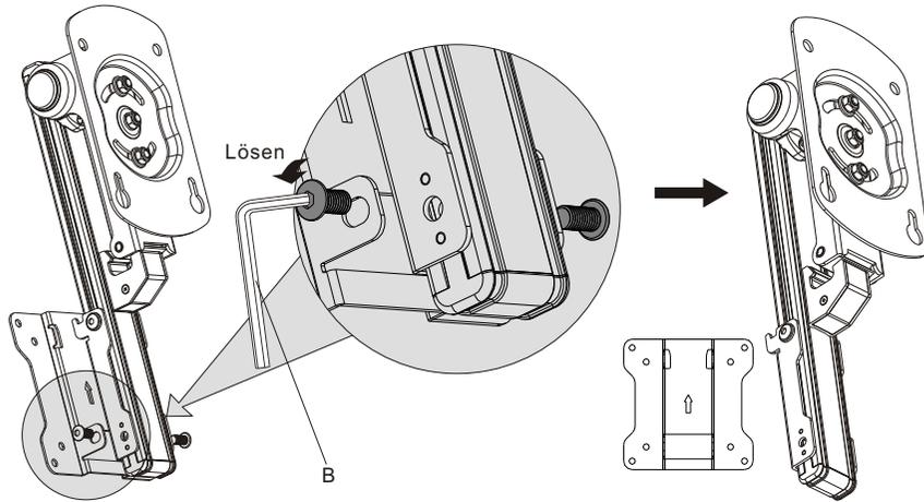
Verwenden Sie den passenden Inbusschlüssel, um die Schrauben der VESA-Platte zu lösen
