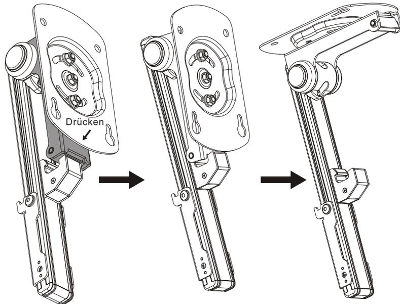
Öffnen Sie die Halterung zur Installation. Drücken Sie die Deckenplatte herunter um die Mechanik zu lösen und den Arm zu öffnen.
