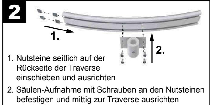
1. Nutsteine seitlich auf der Rückseite der Traverse einschieben und ausrichten
