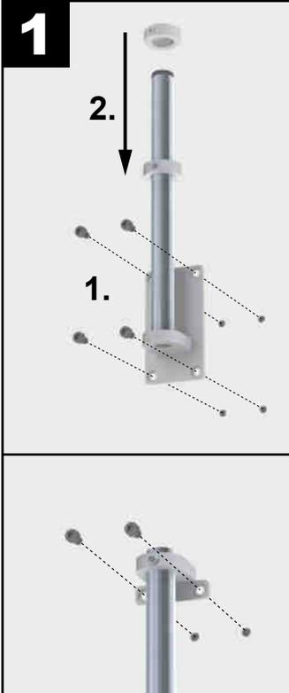
1. Wandhalterung an der Wand mit geeigneten Schrauben befestigen\*
