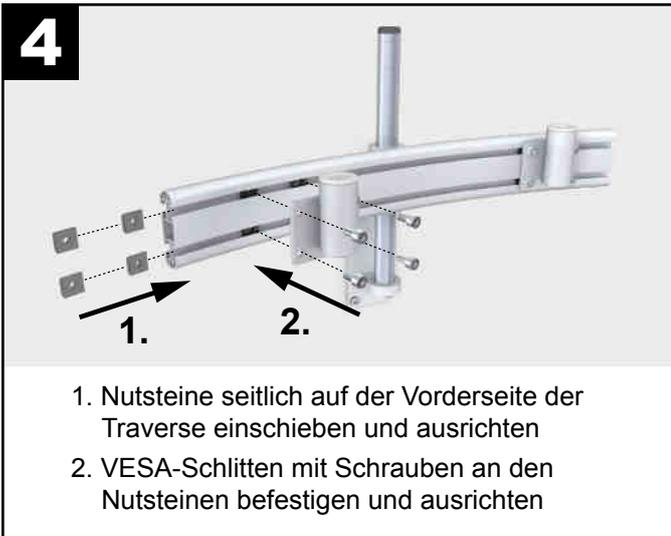
1. Nutsteine seitlich auf der Vorderseite der Traverse einschieben und ausrichten
