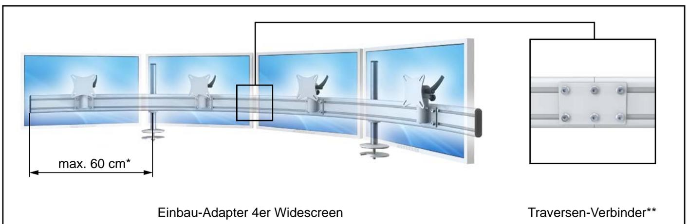
\* Platzieren Sie bei Systemen mit zwei Einbau-Adapter die Säulen in einem maximalen Abstand von 60cm zum Ende der Traverse(n).
