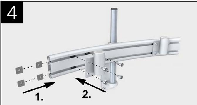
1. Nutsteine seitlich auf der Vorderseite der Traverse einschieben und ausrichten
