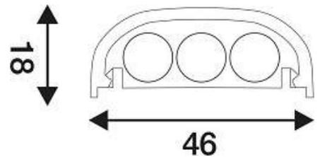
Die NewStar Kabelabdeckung, Modell NS-CC050BLACK, ist eine gute Wahl um Kabel an AV-Installationen zu organisieren. Die Abdeckung versteckt leicht 3 bis 4 Kabel. Das Kabelmanagement verdeckt und führt Kabel von der Flachbildschirmhalterung bis zum Kabelabgang. Verstecken Sie Ihre Kabel, damit die Wand schön und ordentlich bleibt.
