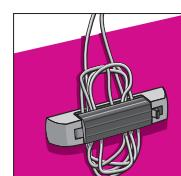
Überlängen werden in Schleifen gelegt; der KabelClip hält sie sicher und fest
