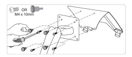
Befestigen Sie die Notebook Ablage wahlweise mithilfe der M4x10 Kreuzschlitzschrauben oder der Knopfdrehschrauben an der VESA-Aufnahme der Halterung.
