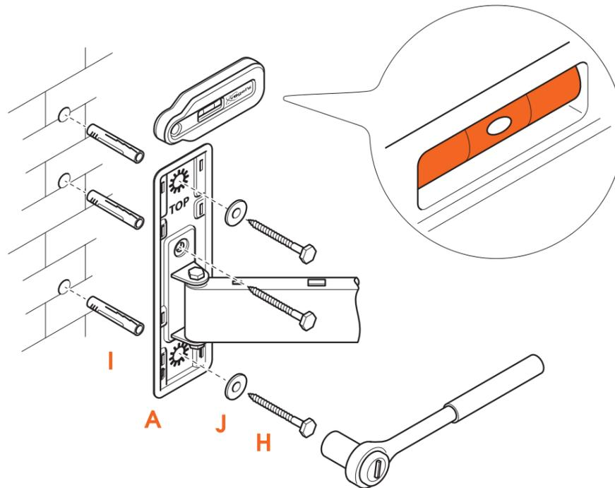
2. Befestigen Sie die **Wandhalterung** (A) mit den **Schrauben** (H), den **Unterlegscheiben** (J) und den **Dübeln** (I) an der Wand. Mit der **Wasserwaage** (C) sorgen Sie für eine waagerechte Montage der Wandhalterung.
