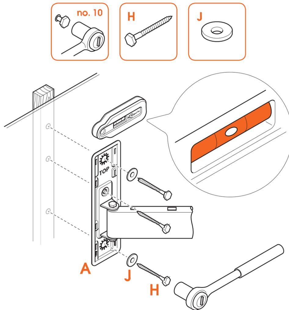
5. Befestigen Sie die **Wandhalterung** (A) mit den **Schrauben** (H) und den **Unterlegscheiben** (J) an der Holzständerwand. Mit der **Wasserwaage** (C) sorgen Sie für eine waagerechte Montage der Wandhalterung.
