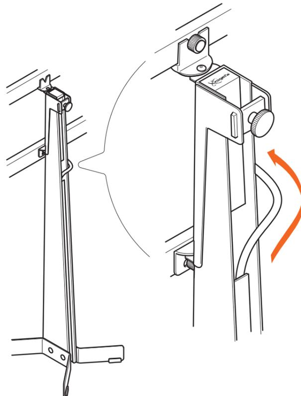
1. Führen Sie die Kabel vorsichtig durch die Rückseite des **Ständers aus Holz / Stahl** ®.
