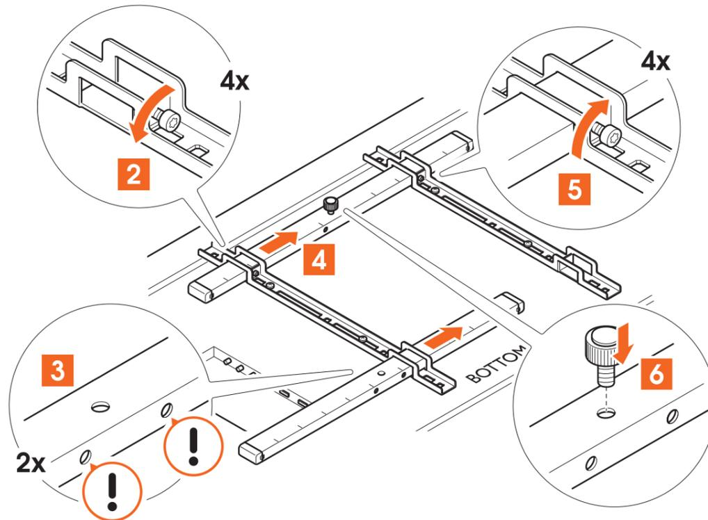
2. Lösen Sie die **vormontierten Schrauben** © mit dem **Inbusschlüssel** ©.
