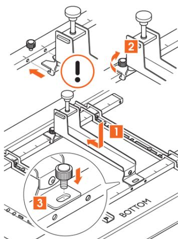
7. Schieben Sie den v-förmig ausgeschnittenen Teil der **Stahlhalterung** Ⓢ auf die obere **Flügelmutter** ®. Achten Sie darauf, dass die Stifte der **Stahlhalterung** Ⓢ in die Löcher der oberen Adapterbar gleiten!
