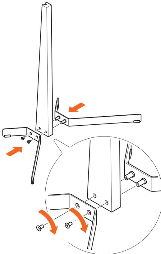
1. Schieben Sie den **rechten Fuß** (mit vormontierten Bolzen) (T) in den **Ständer aus Holz / Stahl** (R). Achten Sie darauf, dass sich das längere Bein vorne am **Ständer aus Holz / Stahl** (R) befindet. Auf der Rückseite des **Ständers aus Holz / Stahl** (R) befindet sich eine versteckte Aussparung für die Kabelführung.
