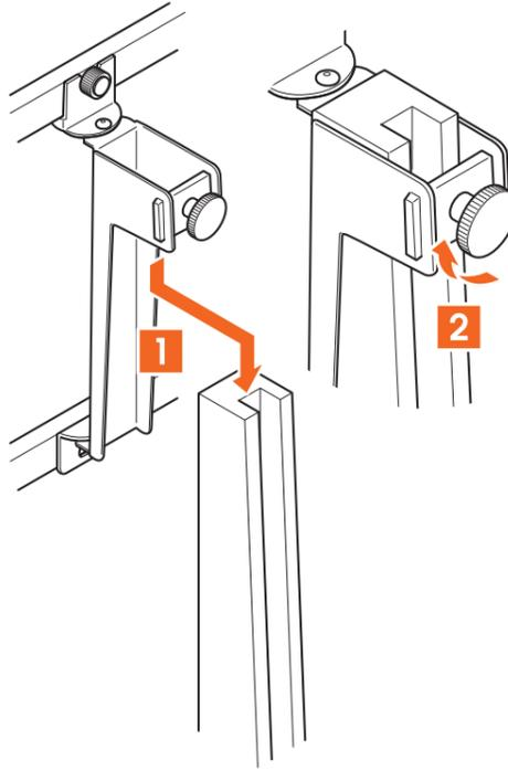
1. Schieben Sie die **Stahlhalterung** ① über die Oberseite des **Ständers aus Holz / Stahl** ②. Befestigen Sie die **Stahlhalterung** ① mit dem Drehknopf (siehe Abbildung) oben am **Ständer aus Holz / Stahl** ②.
