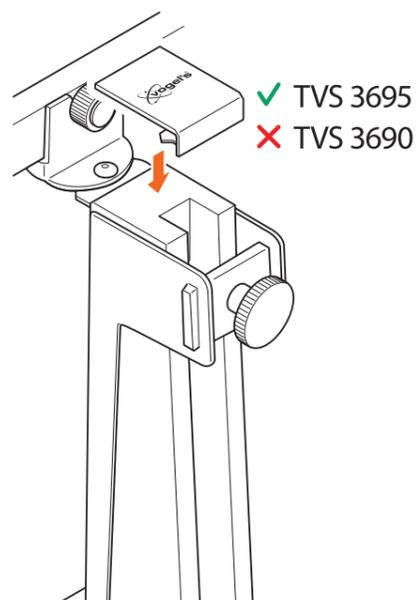
2. Bringen Sie die **Abdeckplatte** aus Edelstahl mit Klickmechanismus ③ auf der **Stahlhalterung** ① an. (TVS 3695)
