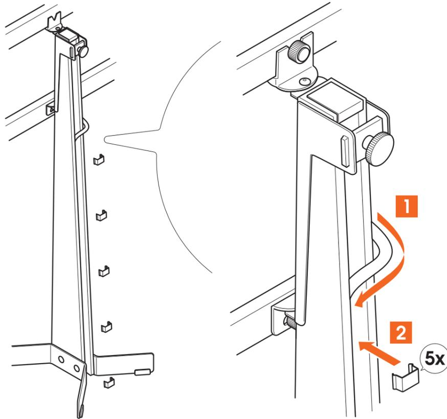
1. Führen Sie die Kabel vorsichtig durch die Aussparung auf der Rückseite des **Ständers aus Holz** ®.
