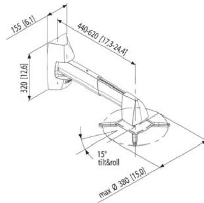
Der Wandhalter PPS 350 wurde speziell für Short-Throw-Projektoren der neuen Generation entwickelt. Dieser Wandhalter verfügt über einzigartige Merkmale speziell für Short-Throw-Anwendungen und spart eine Menge Zeit bei Montage und Einstellung.
