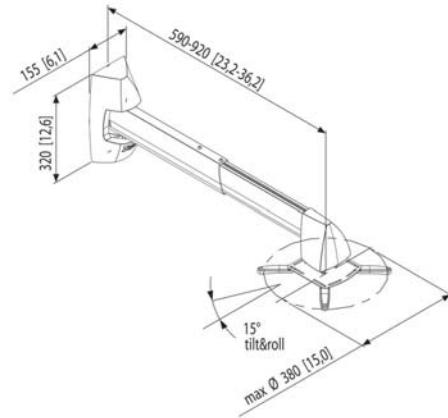
Der Wandhalter PPS 500 wurde speziell für Short-Throw-Projektoren der neuen Generation entwickelt. Dieser Wandhalter verfügt über einzigartige Merkmale speziell für Short-Throw-Anwendungen und spart eine Menge Zeit bei Montage und Einstellung.
